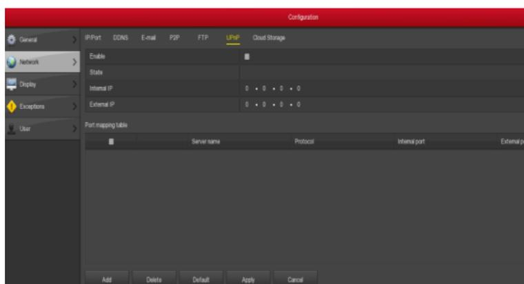
**Enable (Povolit):** Zapnutí / vypnutí funkce UPnP zařízení.
