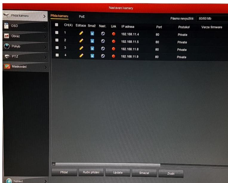
**Add (Přidat):** Klepnutím otevřete rozhraní "**Vyhledávání zařízení**". NVR automaticky vyhledá všechna zařízení v síti LAN, která odpovídají protokolu "**Onvif and Private**". Klepnutím na jednu nebo více vyhledaných adres IP a klepnutím na tlačítko „add“ přidáte vybrané zařízení do seznamu "**Camera add**".
