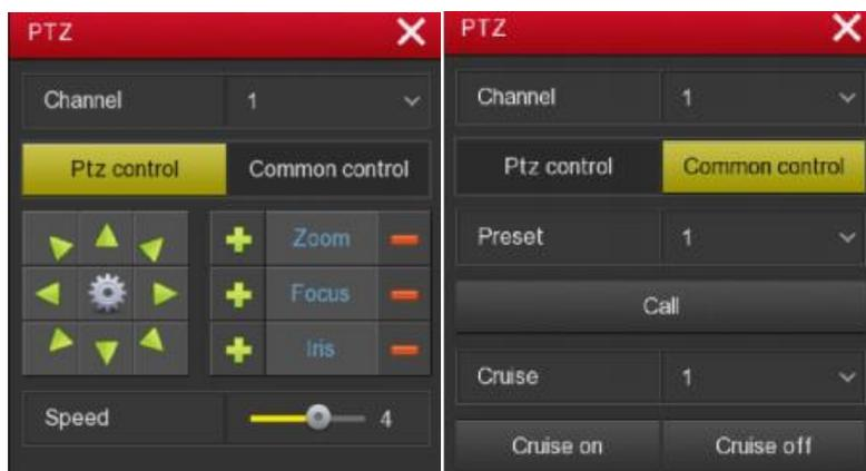
Ovládací rozhraní PTZ je rozděleno na ovládací prvek PTZ a obecné ovládání. PTZ řídicí rozhraní slouží k nastavení směru PTZ, rychlosti a přiblížení objektivu, nastavení zaostření clony. V řídicím rozhraní PTZ můžete přepínat další kanály, nastavit rychlost pohybu PTZ, také můžete řídit směr pohybu.
