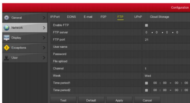
**Enable FTP (Povolit FTP):** Zapnutí/vypnutí funkce FTP zařízení.
