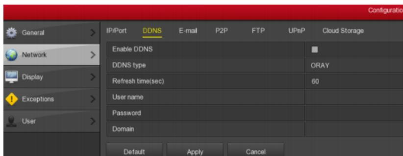
**Enable DDNS (Povolit službu DDNS):** Povolení funkce pro vyřešení domény DDNS.
