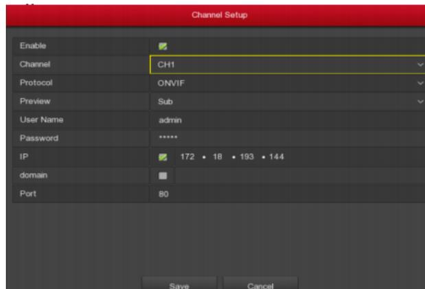
**Enable (Povolit):** Zapnutí/vypnutí kanálu, vypnutí výchozího stavu. Zaškrtněte políčko "Enable" (Zapnout) a potom je možné zobrazit příslušné kanály a nahrát je normálně.
