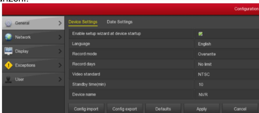
**Enable setup wizard at device startup (Povolit průvodce nastavením při spuštění zařízení):** Klikněte na  a zapněte funkci průvodce po spuštění zařízení.
