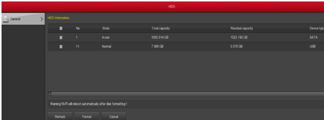
Pokud jste k zařízení úspěšně připojili pevný disk, v seznamu správy HDD se zobrazí informace o pevném disku. Musíte naformátovat HDD, pokud je HDD připojen poprvé. Pokud systém zjistí, že pevný disk není třeba formátovat, na HDD se zobrazí "**Použito**". Pokud se nepodaří úspěšně připojit nebo nedokáže detekovat pevný disk, zobrazí se varování "**Disk nepřipojen!**".
